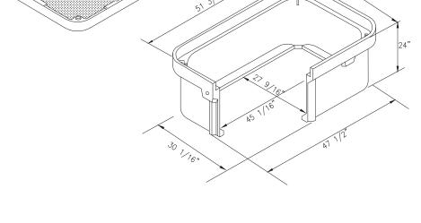
TYPE 48X LIGHTWEIGHT COMPOSITE MATERIAL BOX TAMPER & SLIP RESISTANT LID DETAIL
